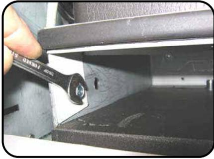
Mit einem 10mm Schraubenschlüssel die beiden Schrauben um 2 Umdrehungen lösen, eine an jedem Ende der Luftauslass-Öffnung. Diese beiden Schrauben aber nicht ganz entfernen.
