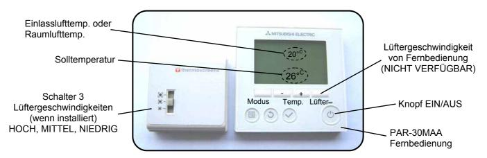
Schalten Sie den Luftvorhang durch Drücken des EIN/AUS-Schalters der PAR-30MAA Fernbedienung aus und die Lüfter des Luftvorhangs stoppen nach einigen Sekunden. Schalten Sie nicht, wenn "Heizen Abtauen" zeigt auf dem Bildschirm, warten Sie, bis 3 Minuten nach dem Abtauen beendet ist.
