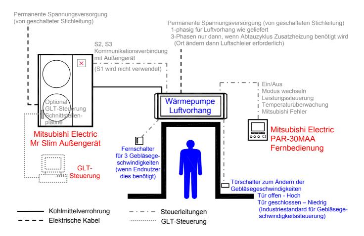
Das Mr Slim HP Wärmepumpen-Luftvorhangsystem besteht aus:
