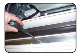
Lösen Sie die Reihe der Schrauben, mit denen die Luftführung befestigt ist (siehe Bild), und dann die Luftführung in den Schlitzen hochziehen. Diese Schrauben aber nicht ganz entfernen.
